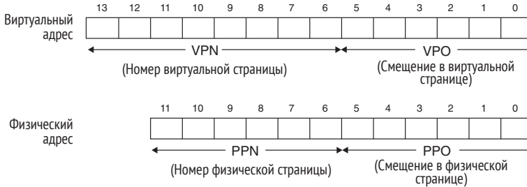
Рис. 9.18. Механизм адресации небольшой системы памяти. Предполагаются 14-битные виртуальные адреса ( n = 14 ), 12-битные физические адреса ( m = 12 ) и 64-байтные страницы ( P = 64 )
