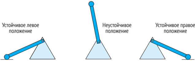
Рис. 6.1. Обратный маятник. Подобно ячейке SRAM, обратный маятник имеет только два устойчивых состояния
