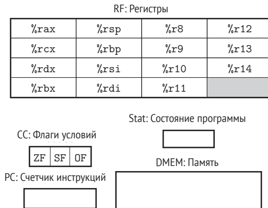
Рис. 4.1. Состояние Y86-64, видимое программисту. Как и в случае с x86-64, программы для Y86-64 обращаются к регистрам, флагам, счетчику инструкций (PC) и памяти и изменяют их. Код состояния программы указывает, нормально ли работает программа или произошло какое-то особое событие
