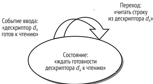
Рис. 12.5. Конечный автомат, соответствующий потоку управления в конкурентном эхо-сервере, управляемом событиями
