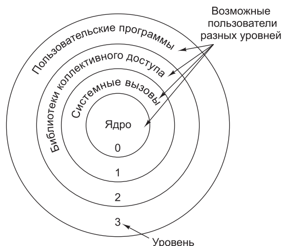
Рис. 6.15. Уровни защиты процессора Core i7
