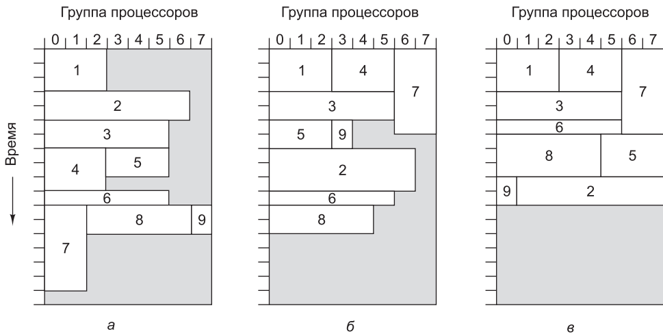
Рис. 8.40. Выполнение заданий в кластере (серым цветом показаны простаивающие процессоры): в порядке FIFO (а); без блокирования начала очереди (б); путем заполнения прямоугольника в системе координат процессоры — время (в)
