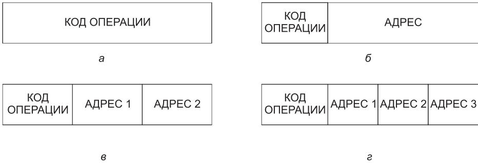
Рис. 5.5. Четыре формата команд: безадресная команда (а); одноадресная команда (б); двухадресная команда (в); трехадресная команда (г)
