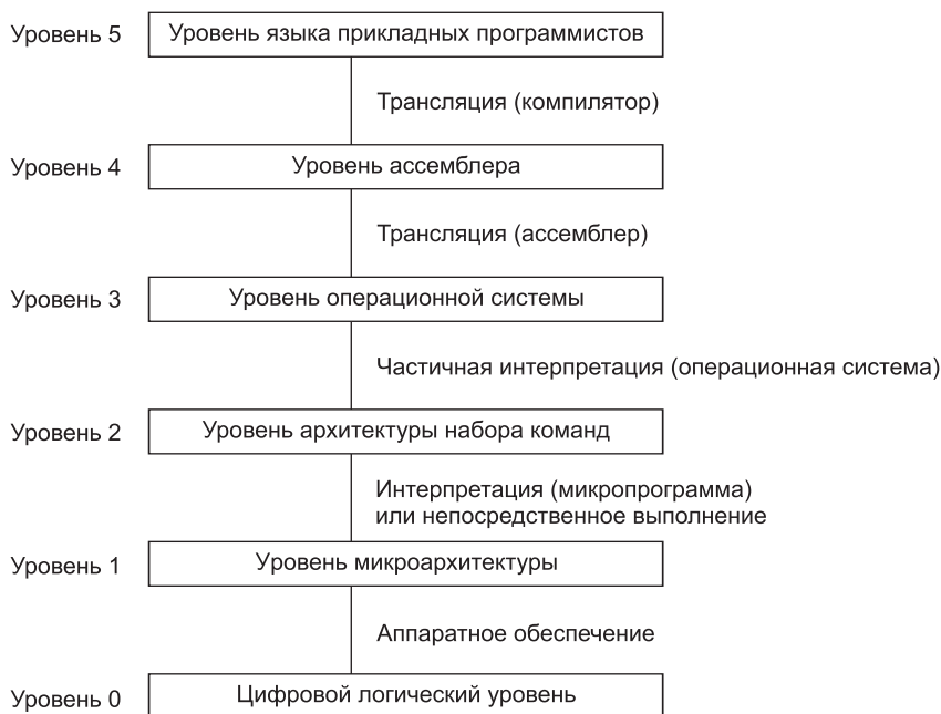
Рис. 1.2. Шестиуровневый компьютер. Способ поддержки каждого уровня указан под ним, в скобках дано название соответствующего программного обеспечения
