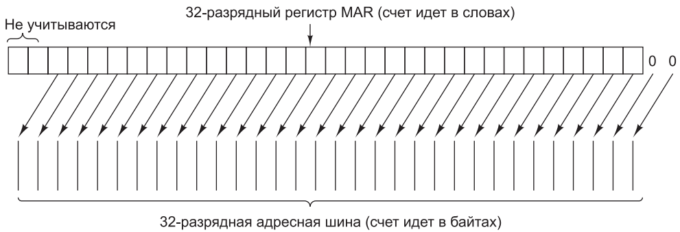
Рис. 4.3. Распределение битов регистра MAR в адресной шине
